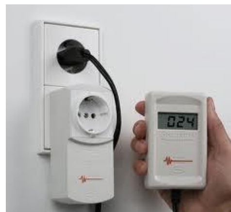
Paso 3: Volver a comprobar lectura después de haber instalado el filtro.
